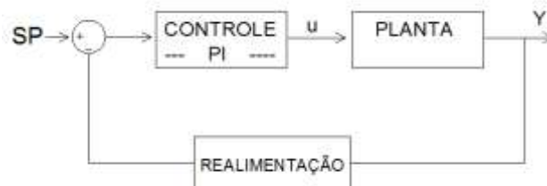
Figura 02 – diagrama de bloco do controle PI
