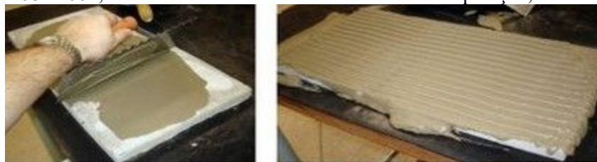
Figura 5 – Imprimação e formação dos cordões sobre o substrato-padrão já imprimado (esq. p/ dir.)
