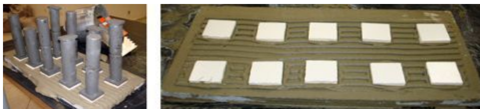
Figura 6 – Carregamento das placas cerâmicas com a massa padrão de 2kg e retirada dos cordões excedentes (esq. p/ dir.)
