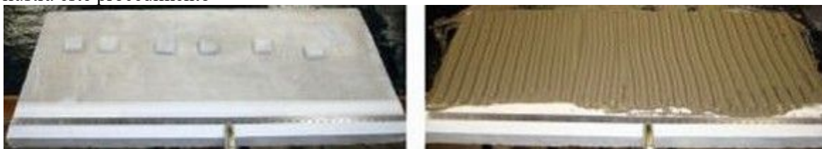
Figura 8 – Preparação do substrato-padrão para o ensaio de deslizamento e aplicação da argamassa
