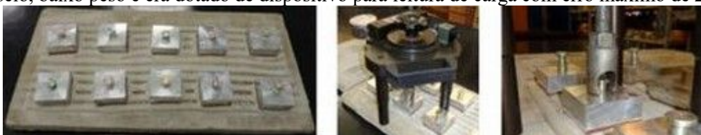
Figura 7 – Condução do ensaio de arrancamento por tração
