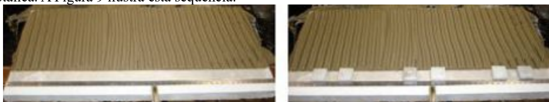
Figura 9 – Retirada da fita adesiva do substrato-padrão e posicionamento dos espaçadores
