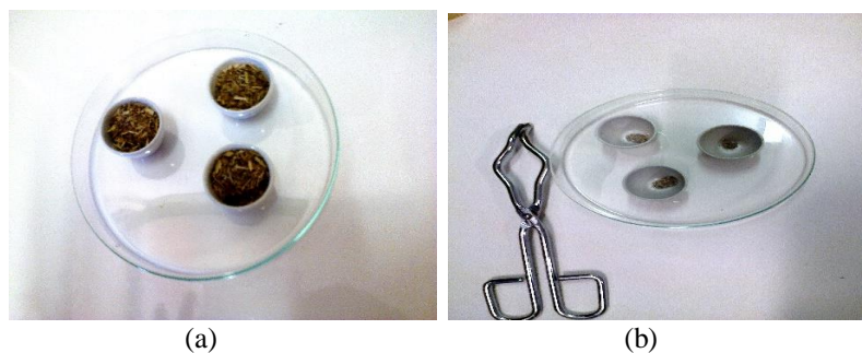
Figura 4 – a) Três cadinhos com 1,0g cada, da biomassa do capim; b) P2, cadinhos após ter passado pela mufla, na forma de cinzas.
