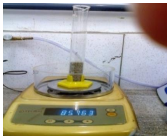
Figura 2 – Pesando a biomassa a cada 20mL da amostra, para determinar a densidade aparente.
