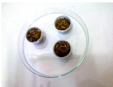
Figura 3 – Três cadinhos com 1,0g cada, da biomassa do capim, dentro de uma placa de Petri.
