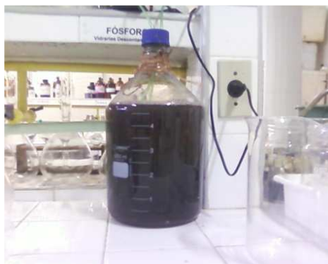
Figura 1- Reator em batelada com biomassa imobilizada de Aspergillus niger AN400.
