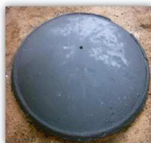
Figura 1 - Molde utilizado para fabricação da parábola do fogão proposto.
