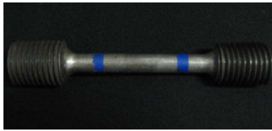
Figura 2 Corpo de prova marcado com tinta.
