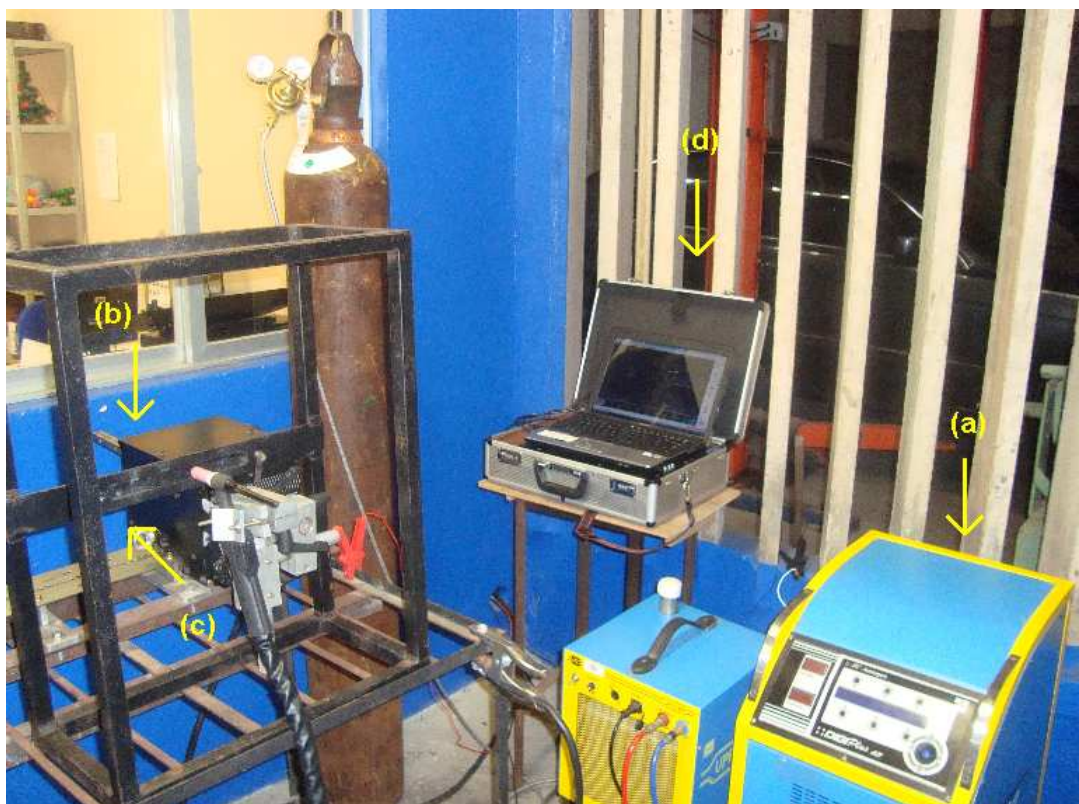
Figura 1. Bancada de soldagem. (a) Fonte eletrônica. (b) Equipamento de soldagem automatizado. (c) Dispositivo de fixação. (d) Sistema de Aquisição Portátil.
