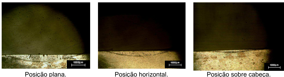
Figura 5. Macrografia dos ensaios PL3, HO2, SC3. x32 .
