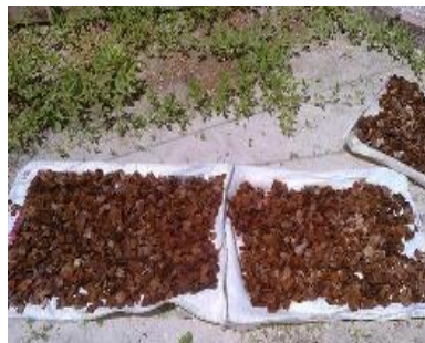
Figura 4 - Etapa de secagem pós-tratamento químico dos cavacos do eucalipto
