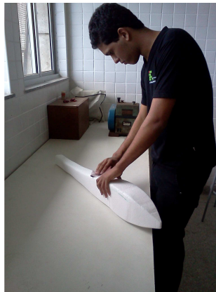
Fig. 08 – Obtida fuselagem 90 cm a partir do Isopor 100mm: Lixando
