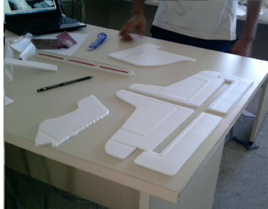
Fig. 06 – Montagem dos estabilizadores
