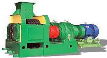
Figura 2 – Briquetadeira de extrusão por rolos Fonte: http://www.lippel.com.br
