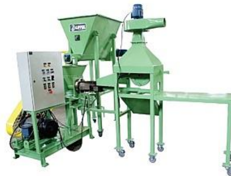
Figura 3 – Briquetadeira de extrusão por parafuso Fonte: http://www.lippel.com.br
