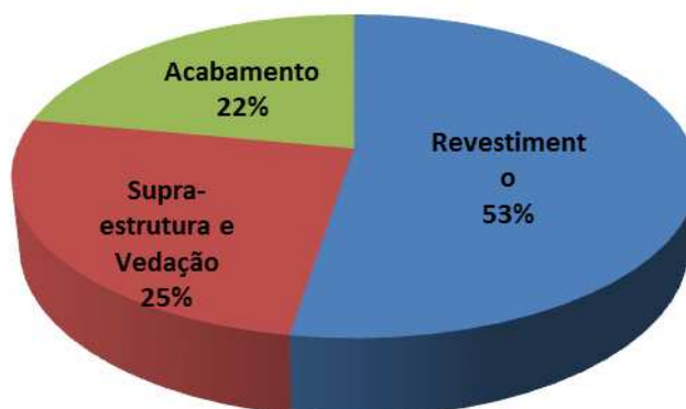
Gráfico 2 - Porcentagem de resíduos de acordo com as fases de execução da obra
