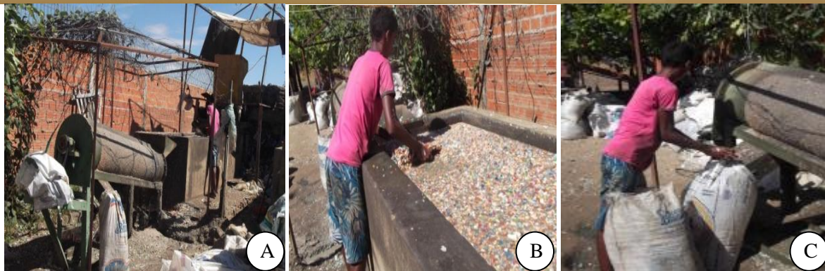
Figura 2 - Procedimentos adotados na Cooperativa. A. Máquina onde ocorre o processamento do material plástico. B. Lavagem do material plástico após sua transformação em partículas menores. C. Empacotamento do material plástico.
