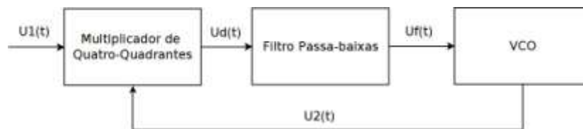
Figura 2 - Diagrama de blocos de um PLL linear, observa-se que este diagrama é mais específico do que o mostrado na figura 1, pois especifica quais são os componentes.
