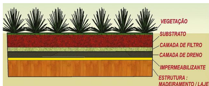
Figura 1 - Camadas de um Telhado Verde
