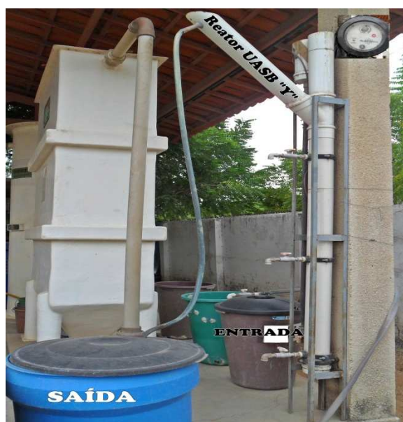
Figura 02: Ilustração do reator anaeróbico em formato de Y.
