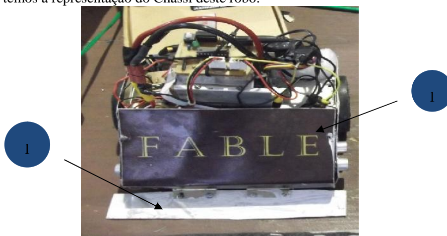
Figura 2 – Chassi do Robô Sumô: 1 – Alumínio 6061 – T6
