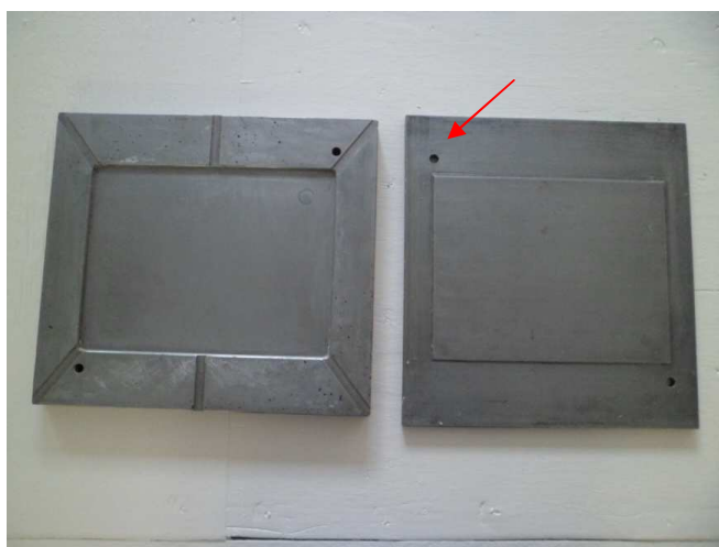
Figura 2- Molde (base e tampa)
