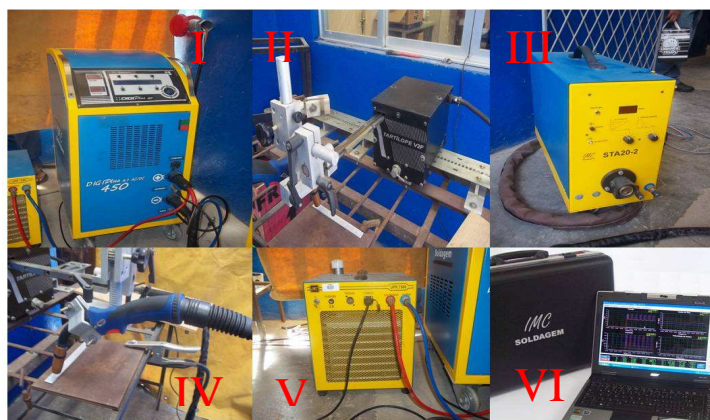
Figura 2. Indica os equipamentos da bancada de soldagem utilizados no processo de soldagem MIG
