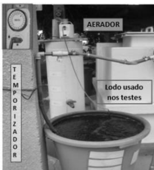
Figura 2: Reator Batelada que gera o lodo para os testes
