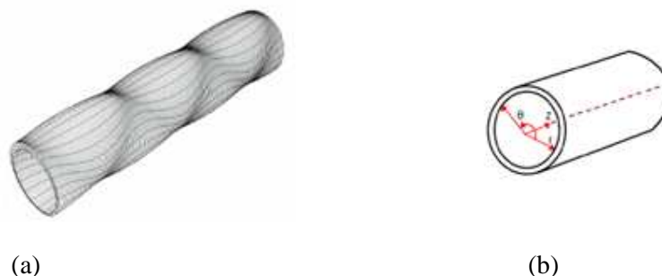
Figura 4- (a) Representação da propagação do modo Flexural. (b) Destaque em vermelho dos deslocamentos do modo Flexural ( u_r , u_z , u_\theta ).
