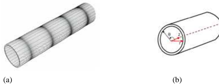
Figura 2- a)Representação da propagação do modo longitudinal ou de compressão. (b)Destaque em vermelho dos deslocamentos do modo longitudinal ( u_r , u_z ).
