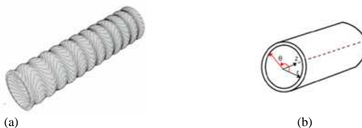
Figura 3- (a) Representação da propagação do modo Torsional. (b) Destaque em vermelho do deslocamento do modo Torsional ( u_\theta ).
