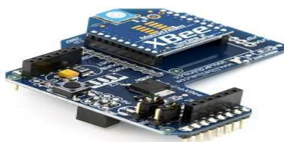
Figura 3 – Shield de Xbee Pro Usado como Base Transceptor dos Comandos.
