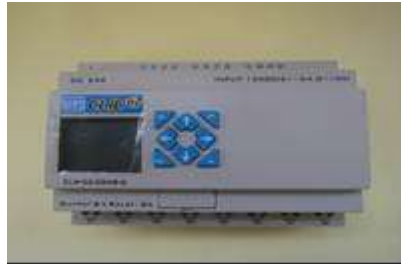
Figura 6 – Descrição do Hardware do CLP.
