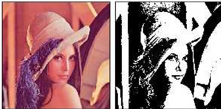
Figura 2 - Exemplo de um limiarizador com limiar = "128"
