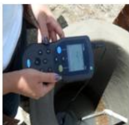
Figura 3. Medição do parâmetro de Condutividade elétrica
