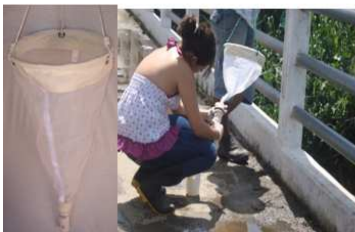
Figura 2 – Rede de plâncton utilizada nas coletas.
