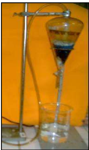
Figura 2 – Esquema do funil de separação com carvão ativo e pedras de quartzo para estabilidade do material acima e algodão na base do carvão
