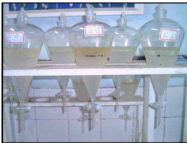
Figura 3 – Esquema de decantação após extração líquido-líquido (água de produção com extratante QAV)
