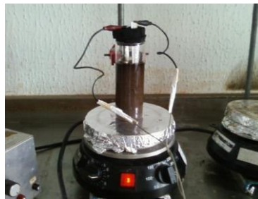
Figura 1 – Processo em batelada da síntese de antioxidante através da reação eletrolítica do LCC em meio alcoólico.
