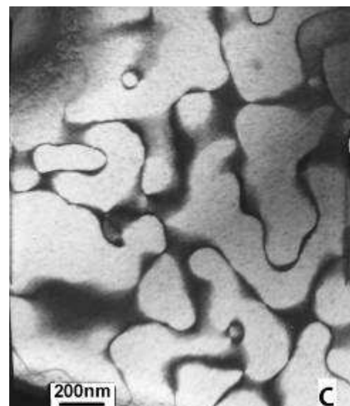
Figura 2 - A) Curvas do tamanho de grão, perdas totais, força coerciva e permeabilidade máxima, em função da temperatura de recozimento. Na condição de B=1T , f=60\text{Hz} e e=0,60\text{mm} . Micrografias de MET: B) Padrão de difração da estrutura ordenada B_2 com eixo de zona (001); C) Contornos dos domínios de antifase B_2 na condição recozida a 1250^{\circ}\text{C} , obtida usando uma reflexão de super-rede 200.
