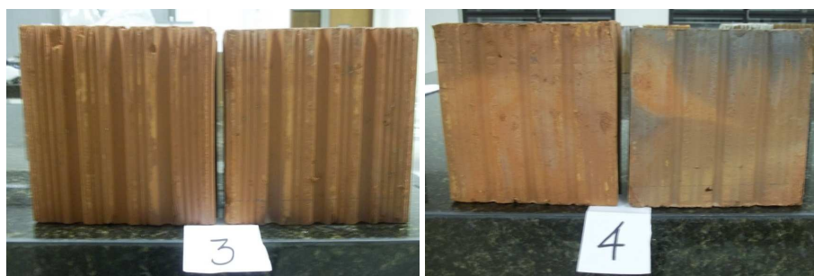
Figura 5 – Blocos 3 e 4, após o ensaio de eflorescência comparado ao bloco em repouso
