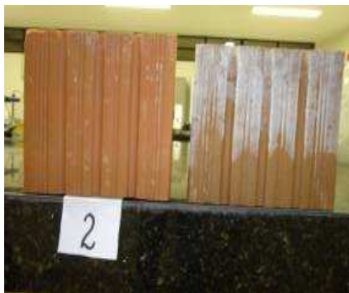
Figura 2 – Comparação dos blocos após o ensaio de eflorescência, segundo a ASTM C 67-92a
