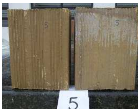
Figura 6 – Eflorescências de cor branca no bloco 5 após o ensaio de eflorescência comparado ao bloco em repouso
