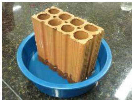
Figura 1 – Bloco cerâmico imerso em água destilada para realização do ensaio de eflorescência, segundo a ASTM C 67-92a
