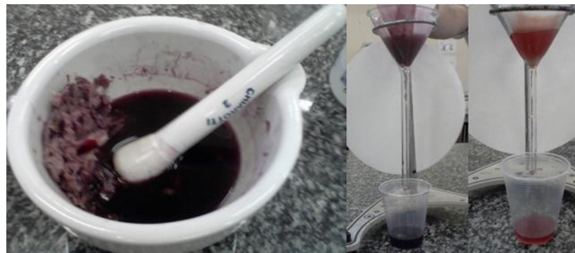
Figura 02 – Maceração das flores (à esquerda), Filtração dos extratos da Hibiscus ssp e da Iroxa ssp , respectivamente (ao centro e à direita)
