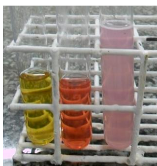
Figura 03 – Experimentação do extrato de Hibiscus ssp como indicador; NaOH (à esquerda), HCl (ao Centro), \text{AgNO}_3 (à direita)
