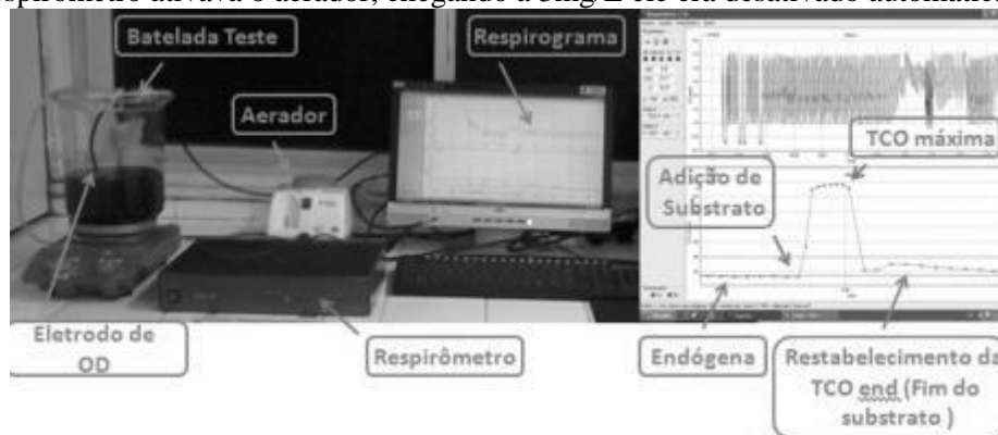
Figura 3: Os componentes do respirômetro e um respirograma.
